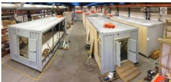
Produktion i Vara i Västergötland av eCentre, en världsledande produkt på den snabbväxande marknaden för prefabricerade modulära datacenter, hos Flexenclosure, ett av Pegrocoss produktbolag och huvudsakliga innehav.
