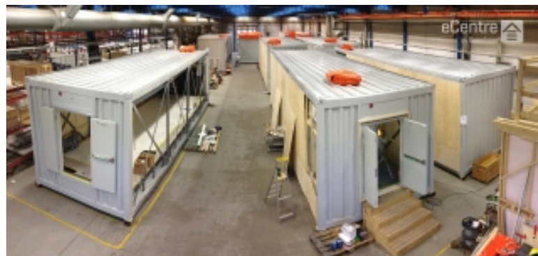
Produktion i Vara av av eCentre, tillväxtbolaget Flexenclosures världsledande produkt inom det snabbväxande segmentet prefabricerade datacenter.
