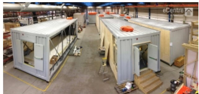
Produktion i Vara i Västergötland av eCentre, en världsledande produkt på den snabbväxande marknaden för prefabricerade modulära datacenter från Flexenclosure, ett av bolagen i Pegrocos Tillväxtportfölj.
